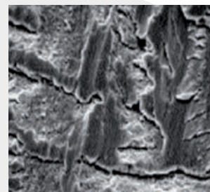
Dopo l'uso di un olio sintetico il cuscinetto risulta consumato.
