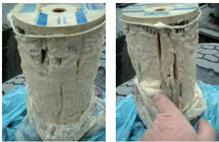
Paraffina del carburante diesel congelata sui filtri
